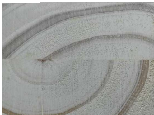
Figura 3: Esquema de uniones en planos semitangencial-semiradial
