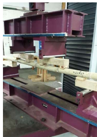
Imagen 2. Probeta de guadua trinii para ensayo flexión estática.
