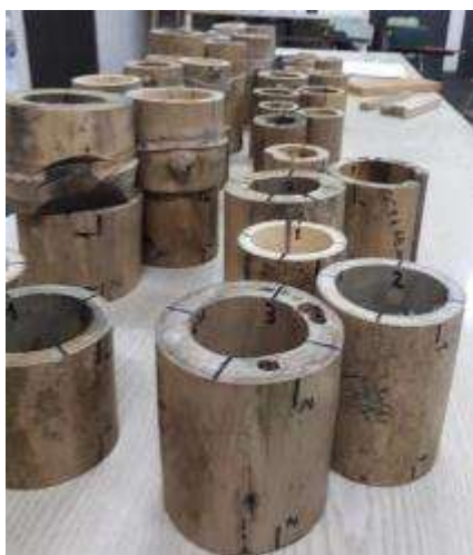
Imagen 2. Probetas para determinar propiedades físicas
