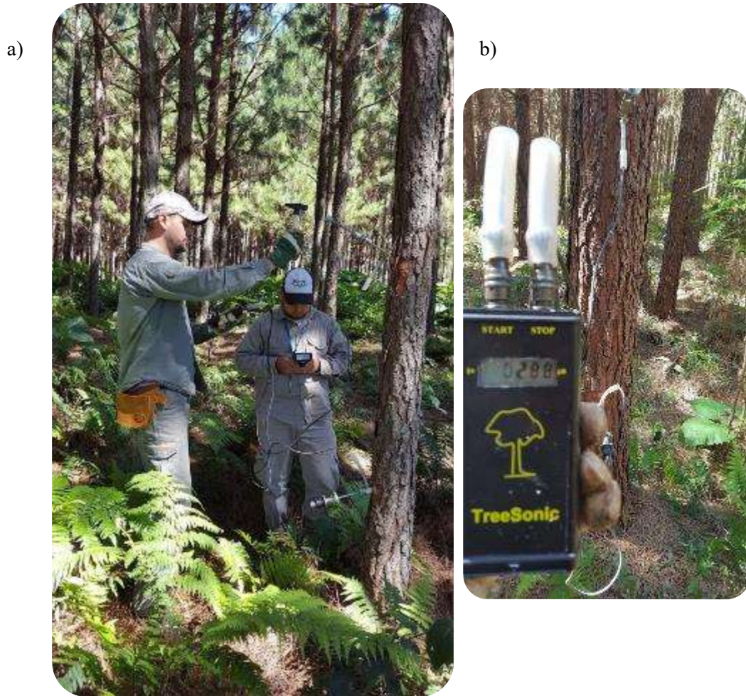
Fig. 1: a) golpes de martillo en sensor de inicio del TreeSonic, b) registro de SWT ( \mu\text{m} ).
