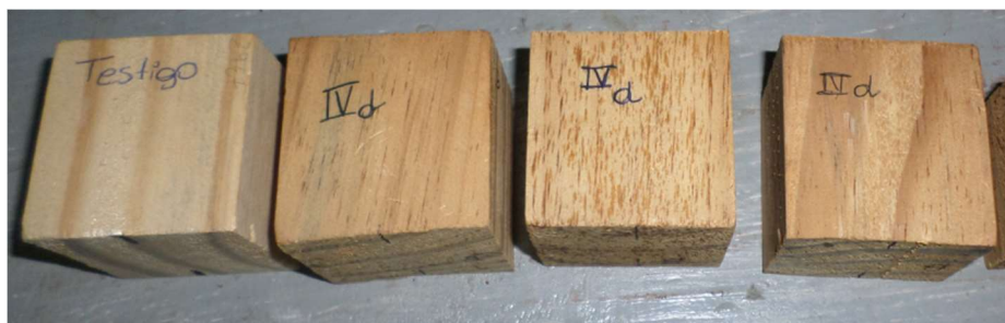
Imagen 2. Probetas testigo y tratadas a 210 °C con tiempo de exposicion de 120 minutos
