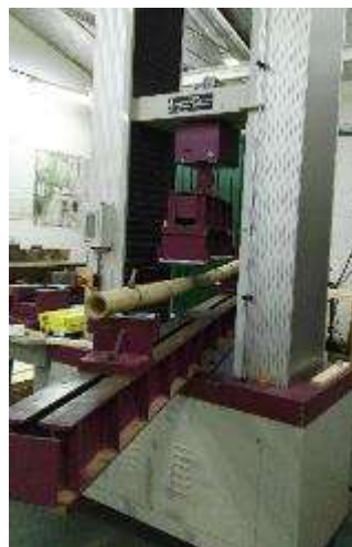
Imagen 3. Probetas y Maquina universal para ensayo de flexión estática
