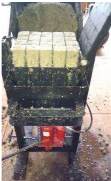
Imagen 1. Prensa neumática con capacidad para prensar veinte briquetas
