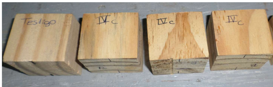
Imagen1. Probetas testigo y tratadas a 210 °C con tiempo de exposicion de 90 minutos
