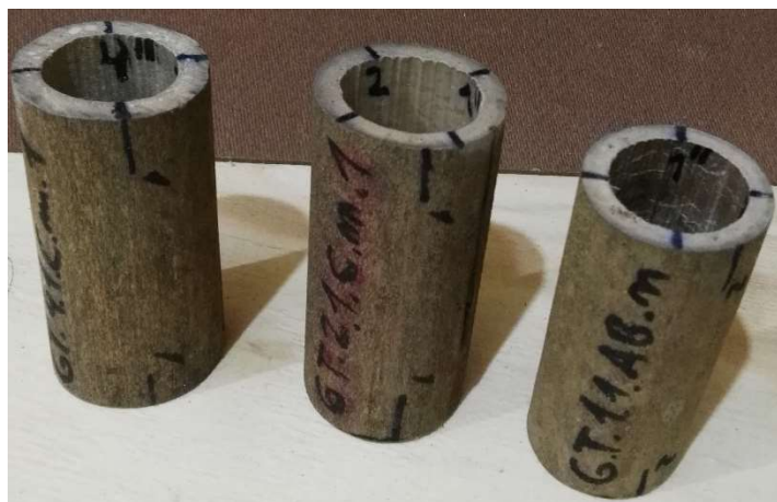
Imagen 1. Probetas de Guadua trinii para ensayos de propiedades físicas.
