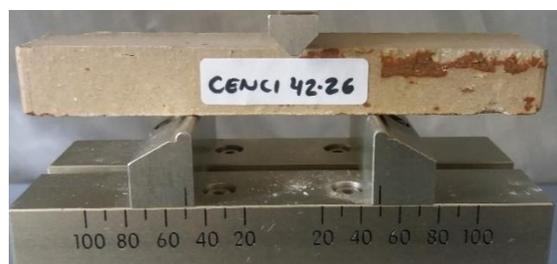
**Figura 2 – Ensaio de flexão**
